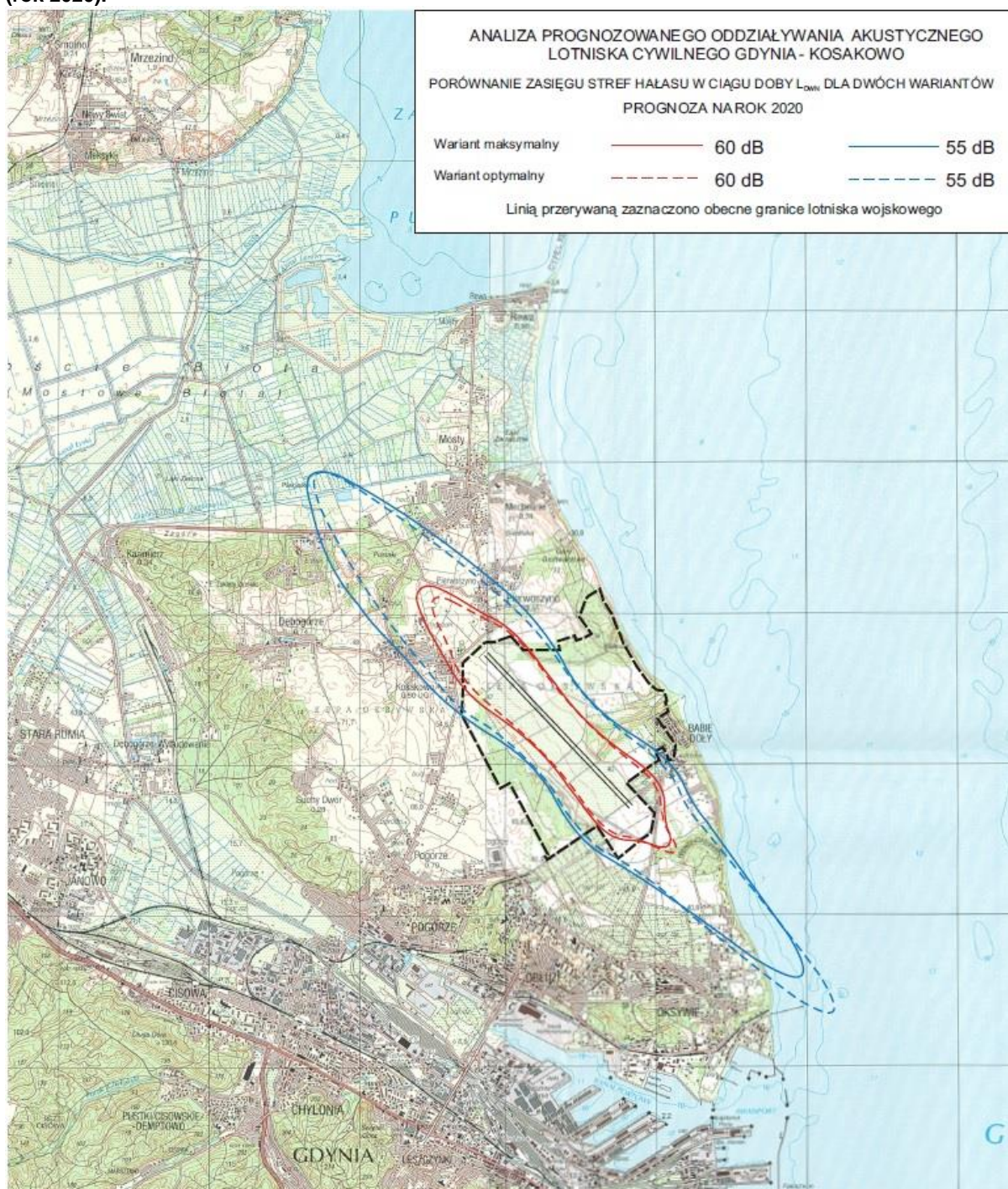
Rysunek 5. Analiza prognozowanego oddziaływania akustycznego lotniska cywilnego Gdynia-Kosakowo (rok 2020).
