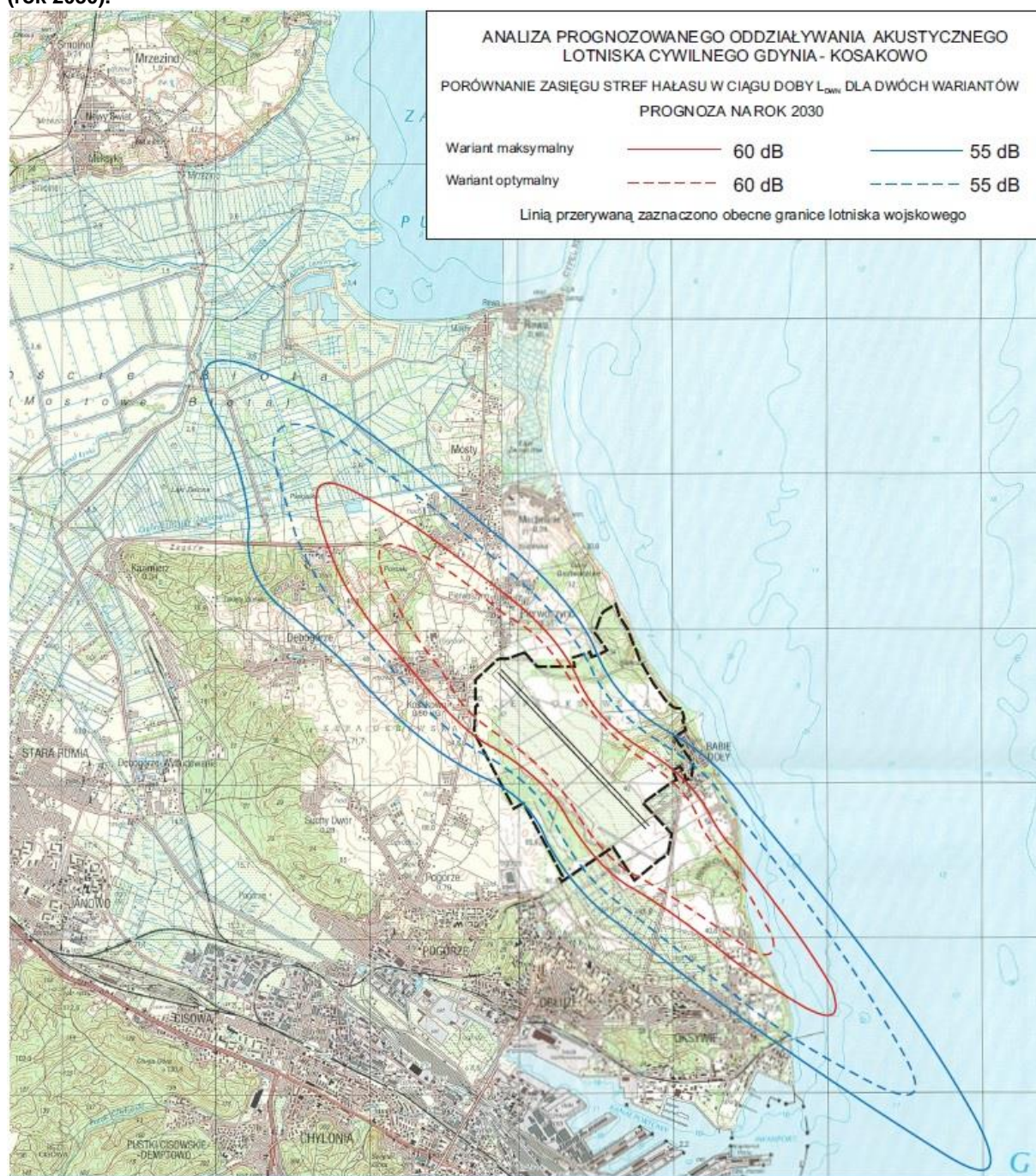
Rysunek 6. Analiza prognozowanego oddziaływania akustycznego lotniska cywilnego Gdynia-Kosakowo (rok 2030).
